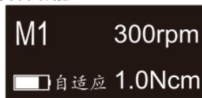
正常情况下连续旋转，当锉遇到的阻力大于预设的扭矩时，马达手柄自动开始以设定的正转反转角度反转交替往复旋转。
