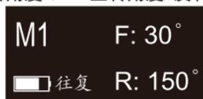
在往复模式下，正转角度和反转角度可以以 $10^{\circ}$ 为步进，在 $20^{\circ}$  - $340^{\circ}$
